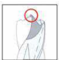
Micropunta: Facile centratura sul materiale e comoda partenza del foro
