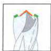
Doppia coppia di taglienti: altissima capacità di taglio con grande resistenza all'usura del tagliente
