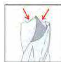
Coppia di rompitruciolo: Evita la formazione di trucioli
