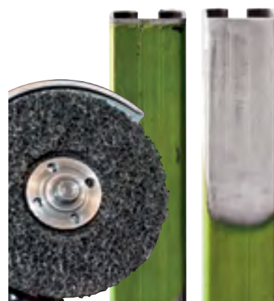
Prima e dopo il passaggio di SCRUBBER su una tubolare verniciato a fuoco.
