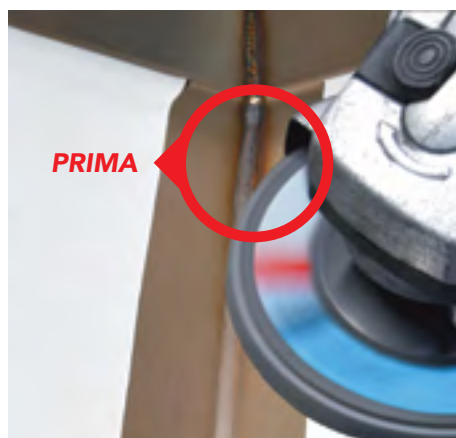
Prima (SN) e dopo (DX) il passaggio di SHINING su un semilavorato in ACCIAIO INOX. SHINING: un ingrandimento della particolare alveolatura del composto.
