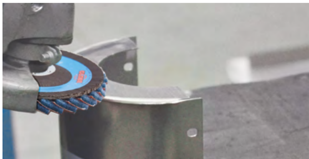
Pulizia e lucidatura di saldature su tubi inox: prima e dopo.
