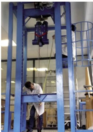
circa. Dopo ogni singola caduta viene verificato che l'imbracatura non abbia rilasciato il torso e che l'angolo di inclinazione tra l'asse longitudinale del piano dorsale del torso e l'asse verticale non sia superiore a 50°. Entrambe le fasi del test dinamico vengono applicate ad ogni punto di attacco progettato per l'arresto della caduta e recante la relativa marcatura.
