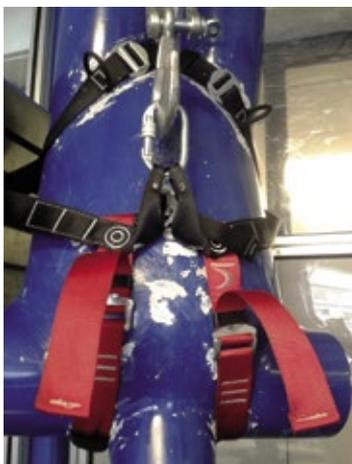
l'imbracatura non abbia rilasciato il torso di prova. Il test viene effettuato per ogni elemento di fissaggio dell'imbracatura.
