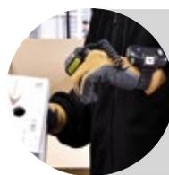
Gli operatori sono dotati di un **finger barcode scanner** che garantisce una fluida operatività tenendo le mani libere.
