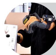
Gli operatori sono dotati di un **finger barcode scanner** che garantisce una fluida operatività tenendo le mani libere.
